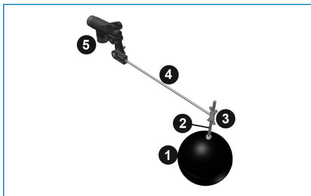
Узел клапана подпитки водой
