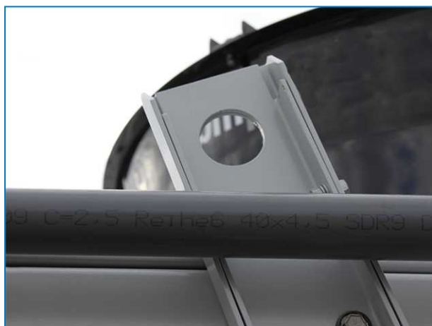
Använd schackel på lyftöglor för att lyfta enheten
