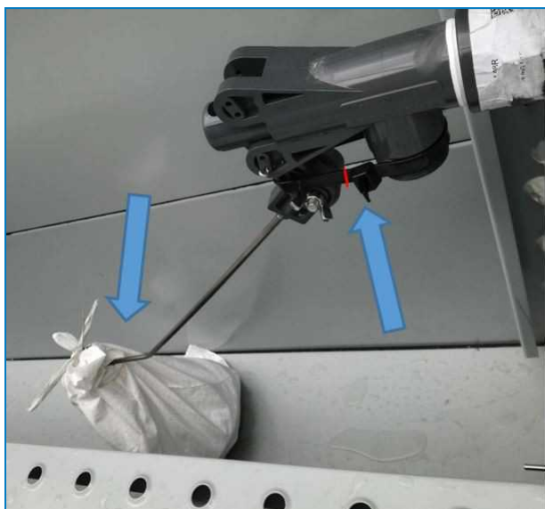
Fastsättning och lindning av flottörkula
