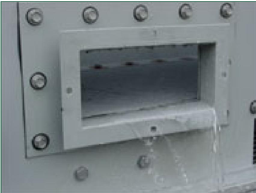
Eine im Werk eingebaute Reinigungsöffnung
