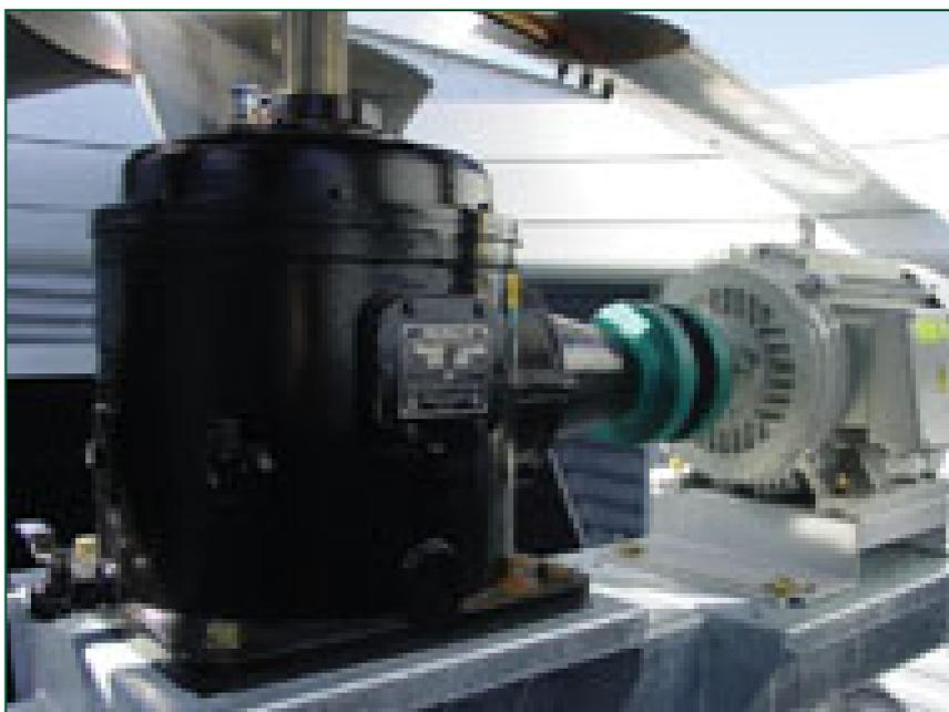
Installé et aligné en usine, le système réducteur renvoi d'angle à moteur à accouplement fixe est une option utile pour **certaines applications industrielles**.
