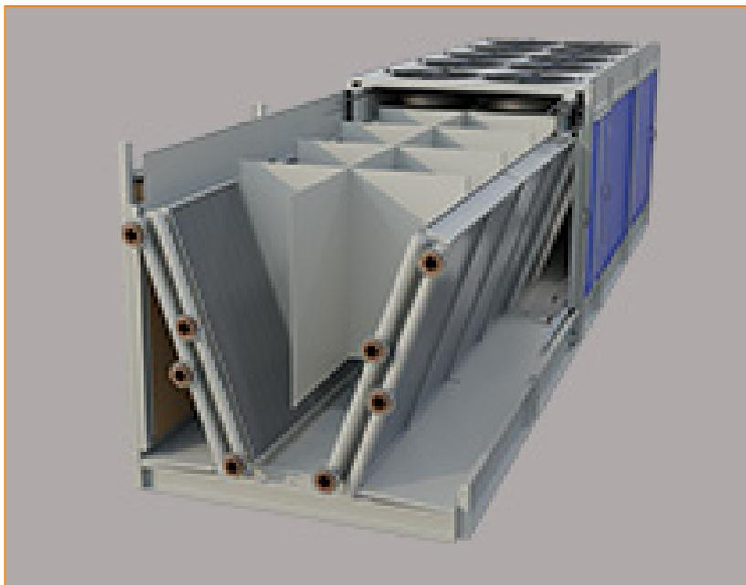
Оснащение изделия разделительными панелями создает **отдельные впускные каналы поступления воздуха на каждый вентилятор** адиабатического охладителя. Это предотвращает падение производительности в случае отказа вентилятора, позволяя избежать ненужного прохождения воздушных потоков через неработающий вентилятор в обход теплообменника.
