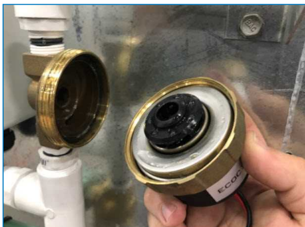
Корпус и улитка насоса
