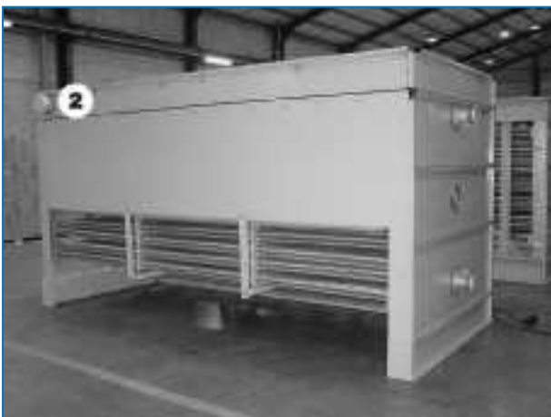
Pumpenrohrleitungsverbindung am Rohrbündelteil
