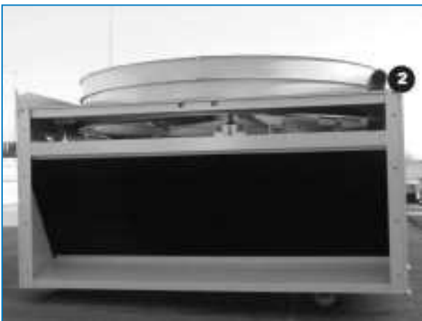
Pumpenrohrleitungsverbindung am Plenumteil außen
