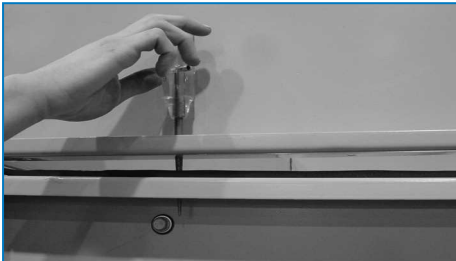
Verwendung des Treibdorns zur Ausrichtung der Schraublöcher
