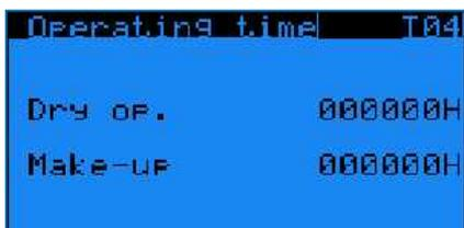
Affichage en heures du temps de fonctionnement des ventilateurs EC, de la pompe, de la vanne d'appoint et du mode sec.
