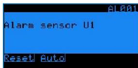
La sonde de température de sortie du fluide (sur l'entrée U1) est défectueuse.
