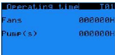
Affichage en heures du temps de fonctionnement des ventilateurs EC et du pré-refroidissement adiabatique.
