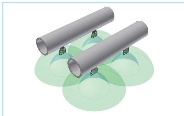
Kühlturm mit geschlossenem Kreislauf des Düsenprühverteilungstyps
