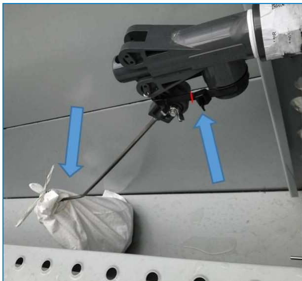
Befestigung und Umhüllung der Schwimmerkugel
